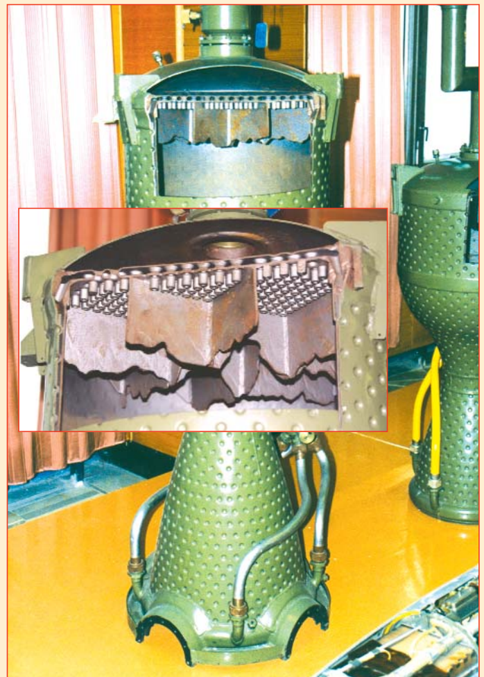
Для борьбы с ВЧ-колебаниями создателям ЖРД приходится искать конструктивные решения, одним из которых стал "крест Исаева"
