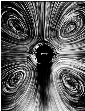
Рис. 5.2. Вторичные вихри, индицируемые колеблющимся цилиндром Течения вокруг цилиндра подобны течениям вокруг Солнца как центробежного насоса.
