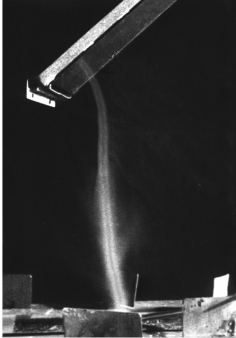
Рис. 5.6. Сжатие газового вихря на входе в воздухозаборник (слева сверху) реактивного двигателя самолета (на стоянке)
