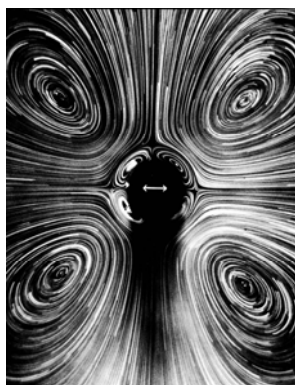
Рис. 17.4. Вторичные вихри, индуцируемые колеблющимся цилиндром. Течения вокруг цилиндра подобны течениям эфира вокруг Солнца как центробежного насоса
