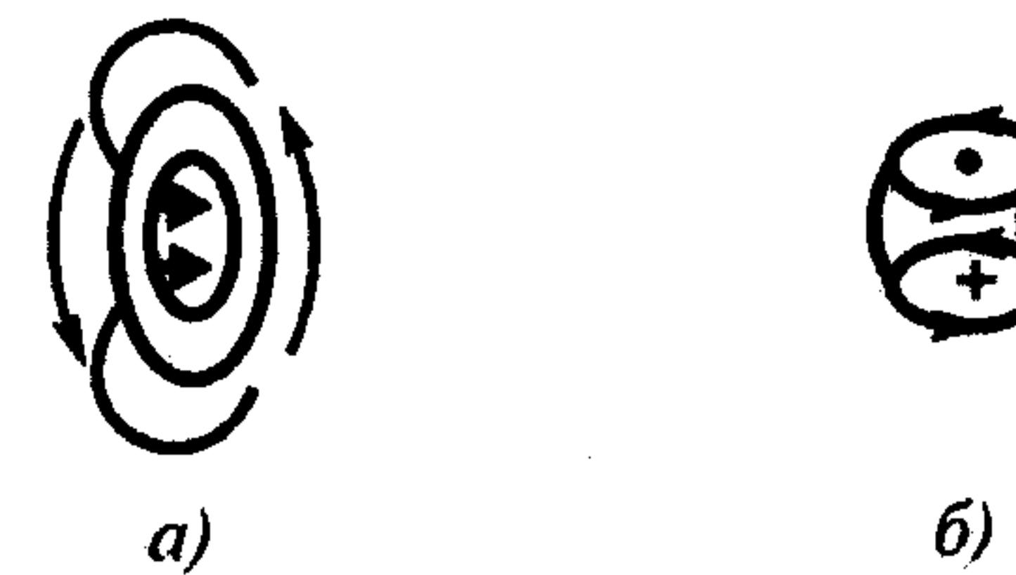
Рис. 8.1. Структура свободного электрона: *а* – в металле; *б* – в свободном пространстве
