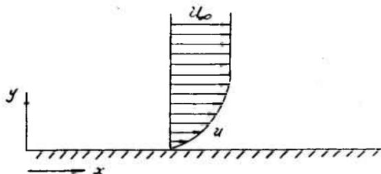
Рис. 4.1. Распределение скоростей в пограничном слое плоской пластины.
