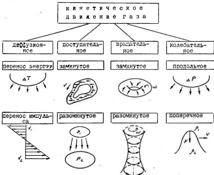
Рис. 3.2. Формы движения газа.
