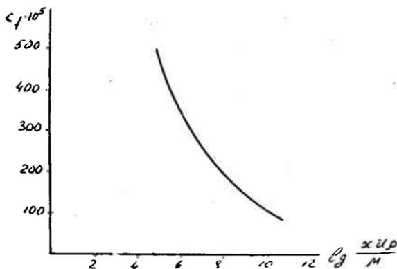
Рис. 4.2. Зависимость между коэффициентом  $C_f$ , отнесенным к плотности  $\rho$  в свободном потоке, и  $Re_x = \frac{x u_0 \rho}{\mu}$  при малой теплопередаче.
