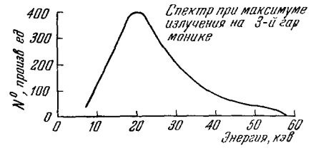
Рис. 17. Изменение энергетического спектра протонов под действием ионно-циклотронной неустойчивости 104
