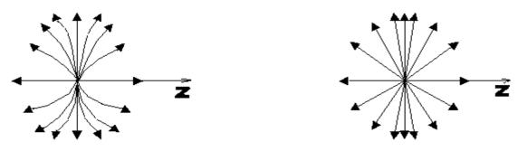
По Хевисайду, поле заряда (который считается точечным), сплющивается в направлении движения в  $\gamma$  раз во всем пространстве. В направлениях , перпендикулярных движению, поле усиливается во столько же раз на любых расстояниях ( правый рисунок).
