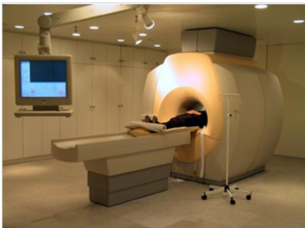
Медицинский томограф со сверхпроводящим магнитом, охлаждаемым жидким гелием. Одной заправки гелия хватает на полгода работы прибора (фото с сайта [www.uni-bonn.de](http://www.uni-bonn.de))
