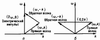
Рис. 3. Дисперсионные диаграммы, поясняющие образование двухимпульсного (а) и трёхимпульсного (б) электроакустического эха.
