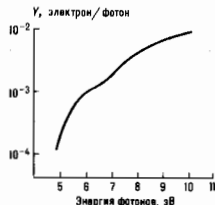
Рис. 1. Спектральная зависимость квантового выхода фотоэмиссии для чистой поверхности Cs.
