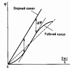
Рис. 2. Фазочастотные характеристики рабочего и опорного каналов фазовращателя на связанных линиях передачи.
