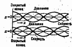
Распределение давлений и скоростей в стоячей волне при открытом и закрытом концах не излучающей звуку трубой.
