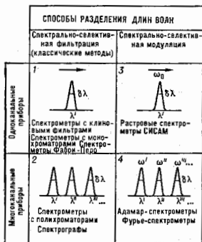
Рис. 2. Классификация методов спектрометрии по числу каналов и способам разделения длин волн. Контуры шириной \delta\lambda символизируют аппаратную функцию (АФ). В одноканальных методах (1 и 3) применяется сканирование (символ \rightarrow ), в многоканальных (2 и 4) — сканирование отсутствует и всемерное интенсивности излучения ряда длин волн \lambda' , \lambda'' , \lambda''' , ... проводится одновременно.
