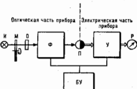
Fig. 4. Блок-схема однолучевого монохроматического прибора: И — источник излучения; Ф — оптический модулятор (объектор); П — сканирующий фильтр (монохроматор); П — фотоэлектрический приёмник излучения; У — усилитель с преобразователем сигналов прибора; БУ — выделитель или цифровой регистратор; БУ — блоки управления и обработки данных на базе ЭВМ.
