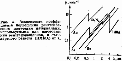
Рис. 4. Зависимость коэффициента поглощения рентгеновского излучения материалами, используемыми для изготовления рентгеношаблонов, и стандартного резиста (ПММА) от \lambda .
