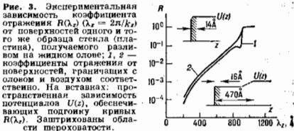
Рис. 3. Экспериментальная зависимость коэффициента отражения R(k_z) ( \Delta x = 2\pi/k_z ) от поверхности одного и того же образца стекла (пластина), получаемого излучением на низком слове; 1, 2 — коэффициенты отражения от поверхности, граничащих с оловом и воздухом соответственно. На вставках: пространственная зависимость потенциалов U(z) , обеспечивающая подложку кривых R(k_z) . Загнтрированы области шероховатости.
