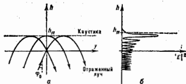
Рис. 1. а — рефракция радиоволн в плоскослойной среде о град n < 0 ; б — зависимость квадрата амплитуды напряжённости электрического поля радиоволн от высоты h .
