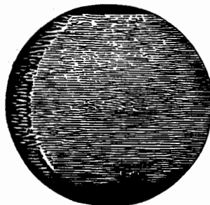
Рис. 2. Фотография промежуточного состояния в сверхпроводящей пластине, полученная методом ферромагнитных порошков. Тёмные полосы — выход на поверхность h -доменов, светлые — S -доменов.
