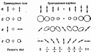
Рис. 1. Проекционные картины электрического вектора при сложении двух волн различной поляризации: параллельные линейная и циркулярная поляризации (а, б) и ортогональные линейная и циркулярная поляризации (в, г) складываемых волн.
