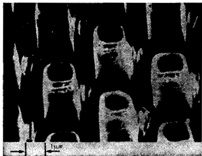
Рис. 16. Члены оптических бистабильных микрорезонаторов GaAs — элемент процессора полностью оптического компьютера. Характерный размер \sim 2 мкм.
