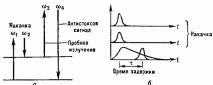
Рис. 6. Схема частотной (а) и временной (б) КАРС-спектроскопии комбинационных резонансов в кубической восприимчивости \chi^{(3)} .
