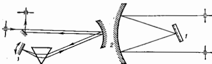
Рис. 2. Автоколлимирующая схема: 1 — зеркало, вращением которого осуществляется сканирование спектра.
