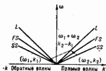
Рис. 7. Дисперсионная диаграмма встречного коллинеарного взаимодействия бездисперсионных акустических волн: быстрой сдвиговой ST и медленной сдвиговой ST с образованием продольной волны L суммарной частоты.
