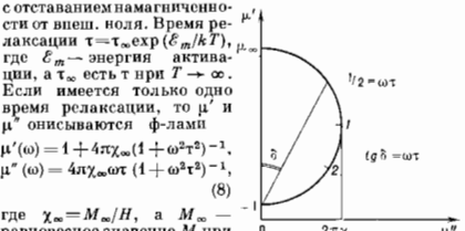
Рис. 3. Диаграмма Аржана (или Коле и Коле) зависимости \mu' = f(\mu'') .
