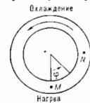
Рис. 2. Конвективная петля — физическая модель, для которой выводится уравнение Лоренца.
