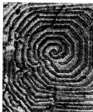
Рис. 9. Двухосевая спираль, образующая вициальный холмик вокруг точек выхода на поверхность двух дислокаций: а) общий вид холмика; б) его сечение плоскостью, перпендикулярной грани и проходящей через точки выхода дислокаций; в) спираль на грани (100) синтетического алмаза.
