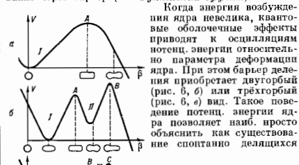
Рис. 6. Потенциальная энергия V ядра как функция параметра деформации \beta , характеризующего его форму в процессе деления. Визуал — схематическое изображение эволюции формы ядра в процессе деления.
