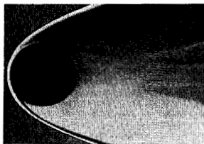
рис. 4. Фотография сферы, летящей с гиперзвуковой скоростью.
