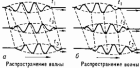
Рис. 2. Последовательные моменты времени снимки группы волн и моменты времени t_1, t_2, t_3 в случае нормальной дисперсии (а) и в случае аномальной дисперсии (б).
