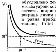
Рис. 1. Зависимость ширины Г-линии мессбауэровского излучения от времени жизни изомера \tau ; нижняя кривая соответствует естественной ширине линии, сплошная линия — результат экспериментов.
