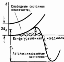
Энергетическая диаграмма кристалла при наличии автолокализации; волнистые линии изображают туннелирование в автолокализ. состоянии, штриховые линии — резонансы.
