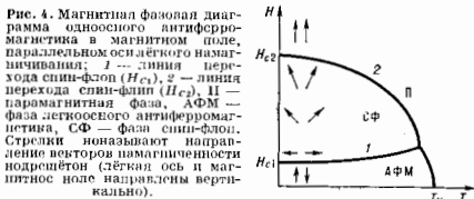
Рис. 4. Магнитная фазовая диаграмма одноосного антиферромагнетика в магнитном поле, параллельном осн. легкой намагниченности: 1 — линия перехода сини-фаз ( H_{c1} ), 2 — линия перехода сини-фаз ( H_{c2} ). II — парамагнитная фаза, АФМ — фаза легкоосного антиферромагнетизма, сф — фаза сини-фаз. Стрелки показывают направление векторов намагниченности подрешёток (с и и) оси и магнитное поле направлено вертикально).
