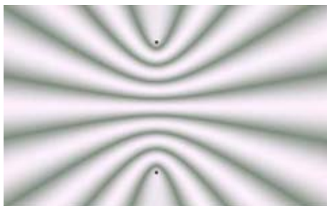
Рис.8 Сдвига фаз нет. Ориентация к перемещению в среде перпендикулярная ( \theta=90^\circ ). Скорость перемещения V=0,75c . Направление перемещения слева направо. Интерференционное поле сжалось. Появились дополнительные пучности и узловые зоны. Расстояние между узлами стоячей волны сократилось.
