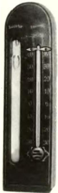
Внешний вид «бароскопа»: слева – стеклянная ампула с раствором, из которого время от времени выпадает кристаллический осадок; справа – термометр со шкалой Реомюра.
